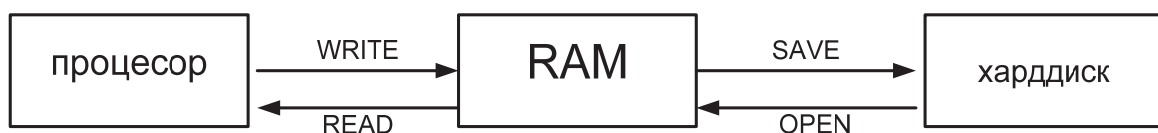
Слика 2.5. Функција на RAM-от како работна меморија на микропроцесорот
