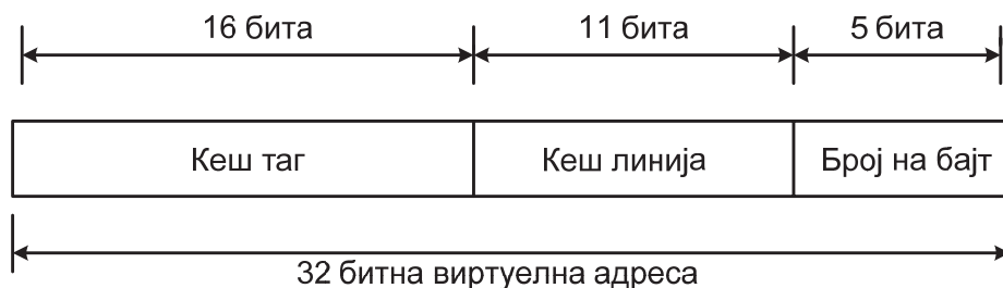
Слика 4.5. Виртуелна адреса за пронаоѓање на податок од кеш меморија
