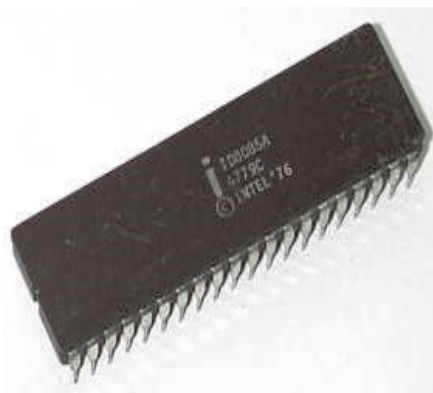
Слика 2.2. Надворешен изглед на микропроцесор
