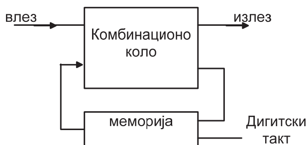
Слика 1.21.Принцип на работа на секвенцијалните кола
