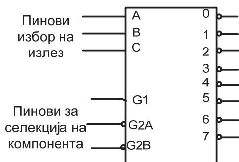
Слика 4.19. Пин дијаграм на декодер 74LS 138
