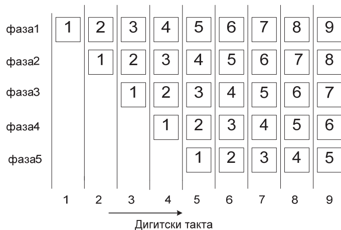
Слика 3.11. Зависност на фазите од времето кај проточниот концептот
